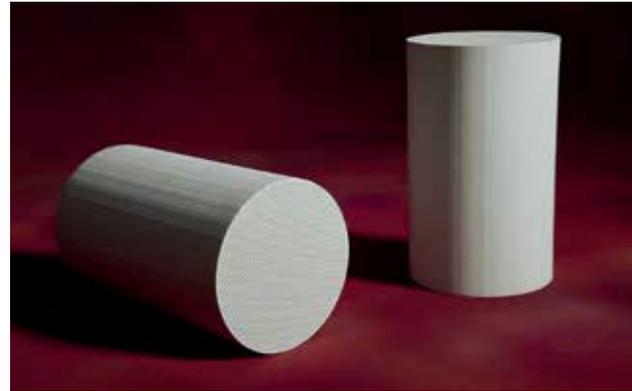
Fidys™ wird in einem Stück extrudiert (Monolith) und die Rohstoffauswahl (natürlich vorkommende oxidische Minerale) erfordert deutlich weniger aufwendige Bedingungen beim Brennen der Keramik. Überdies ist eine Vakuum- oder Schutzgasatmosphäre im Brennofen nicht erforderlich.
