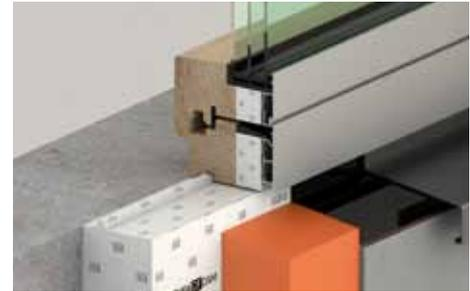
Durch die universelle Produktion als Stab-, Block- oder Plattenmaterial in unterschiedlichsten Fräs- und Zuschnittvarianten können individuelle Anpassungen an vorhandene Profilgeometrien oder Bauteilkonturen angeboten werden. Der Längenzuschnitt erfolgt individuell auf der Baustelle mit einfachsten Werkzeugen.
