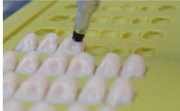
Am Beispiel der Manipulation von Kunststoff-Prothesenzähnen wurde dieses System konzipiert und konnte dabei die Online-Erkennung des Zahntyps, die spezifisch individuelle Lage der Zähne, die Manipulation mittels Greifeinheit eines Schwenkarmroboters, die Platzierung auf einer sogenannten Gegenform und einen abschließenden Pressvorgang auf Wachsleisten gewährleisten.
