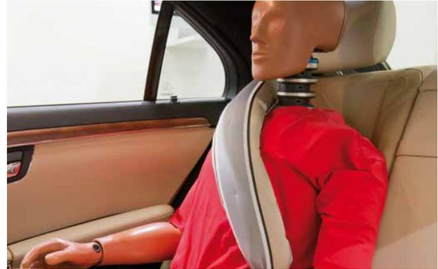
Neben den hohen mechanischen Anforderungen an das System musste der Innenschlauch so konstruiert werden, dass er vom Fahrgast mit geringsten Materialstärken für höchste mechanische Belastungen kaum spürbar ist. Anwendung findet dieser neue Gurt-Airbag für Fahrzeuginsass/-innen auf den Rücksitzen. Der Beltbag wird bereits seit Mai 2013 im Top-Modell von Daimler, der Mercedes S-Klasse, eingebaut.
